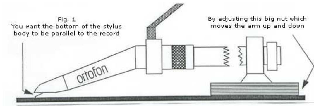
**Alignez la cellule** dans les fentes du porte-cellule si vous utilisez une cellule standard de 13 mm. Utilisez la carte d'alignement fournie avec la platine. Si vous n'en avez pas, placez la cellule à mi-hauteur des deux fentes du porte-cellule. Si vous utilisez une cellule Ortofon Concorde, aucun alignement n'est requis car elle se visse directement dans le bras.
